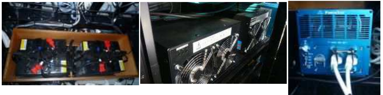
図 1.2-55 バッテリー・AVR ユニット・コンバータ・インバータ
