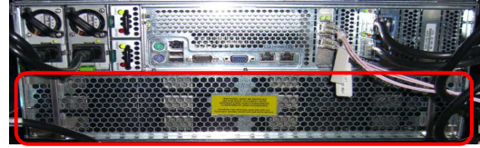
筐体背面に HDD12 基
