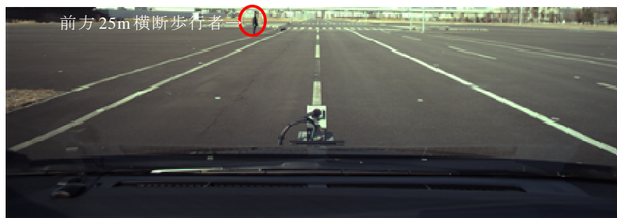
図1.2-66 前遠方監視カメラ（画角90°）映像データ例（前方25m地点左側に横断歩行者）
