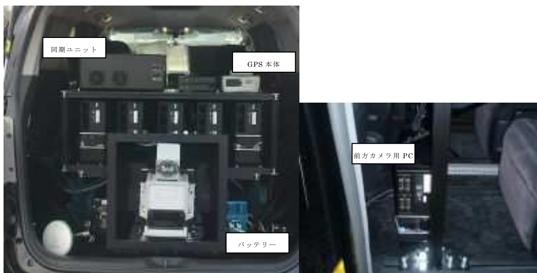
図 1.2-52 PC 他の機材配置
