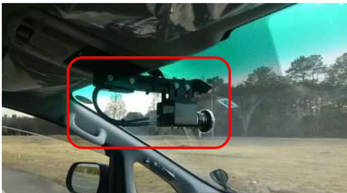
図 1.2-51 前遠方監視用カメラ
