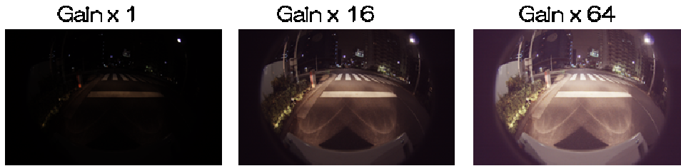
図序 4.1-7 夜画像 Gain 調整結果(シャッター速度 15.3ms 2015/2/25 21:35 新橋曇り)
