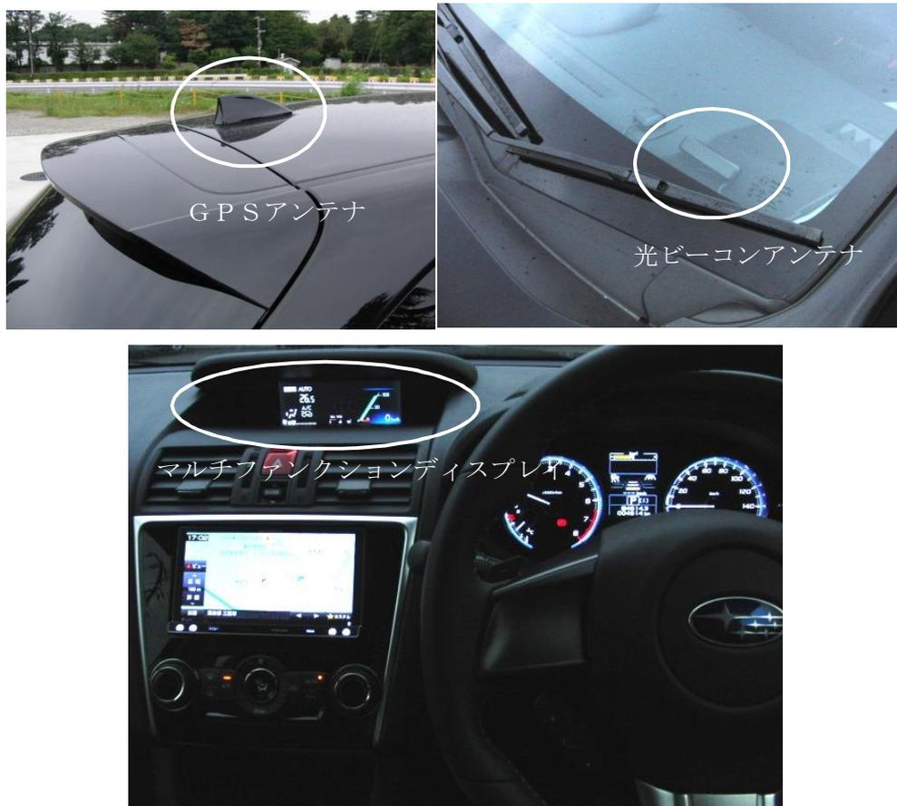
図 5.2-4 アンテナ設置状況及びHMI設置状況
