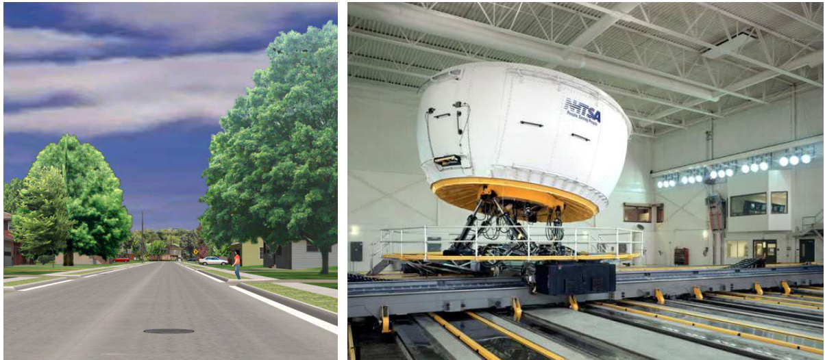
図 4.1.1-1 歩行者との遭遇シナリオ例（左図）とドライビングシミュレータ外観（右図）
