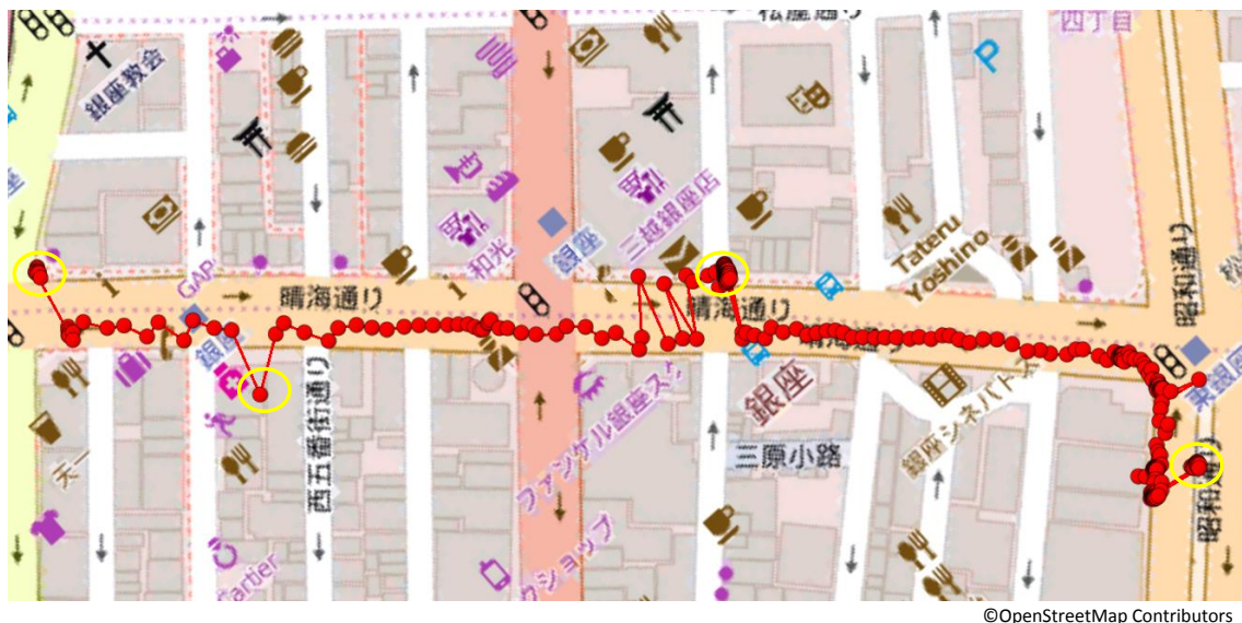
図 7.1.2-10 1Hz に変換した観測ファイルをそのまま使用し単独測位
