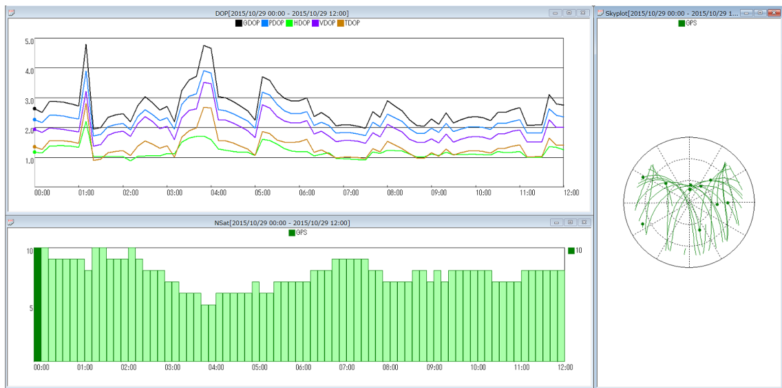
図 3.5.2-8 GPS の衛星飛来予想: 2015/10/29 0:00~12:00(UTC) Station: JAXA 筑波宇宙センター / 仰角マスク 15^{\circ}
