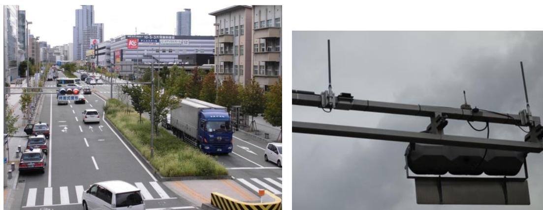
図 5.3.4-3 : 設置交差点例と路側機アンテナ
