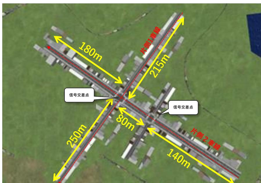
図 5.3.3.3.1-7 ドライビングシミュレータ上の実験コース
