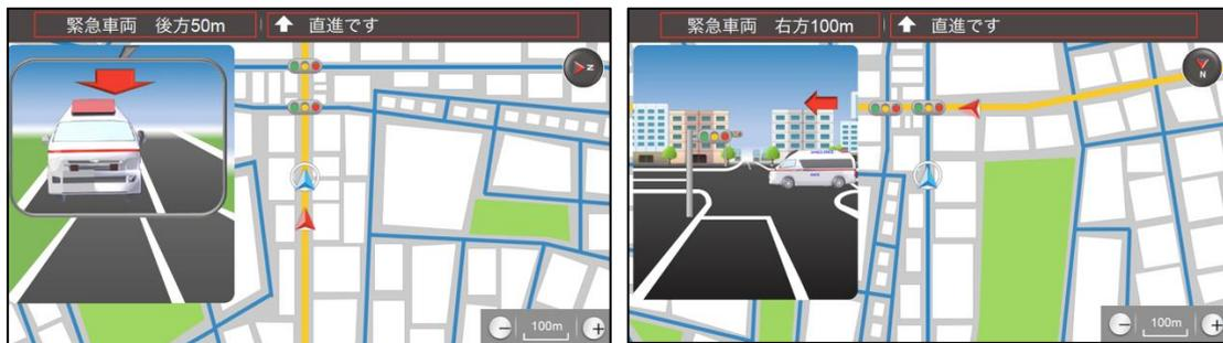
図 5.3.3.3.1-9 救急車接近通知モードのナビ画面（左：後方接近時、右：側方接近時）
