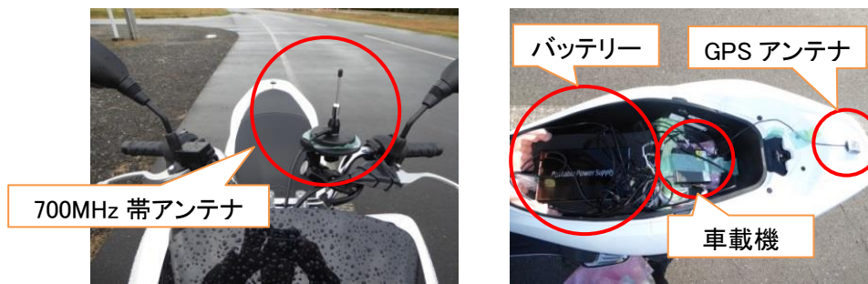
図 5.1.5.1-10 構成 D : 二輪車両搭載時の様子
