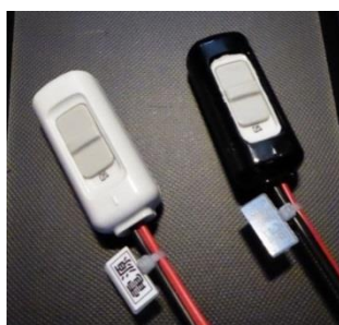
図 5.1.4.2-13 ドライブレコーダ動作制御用スイッチ
