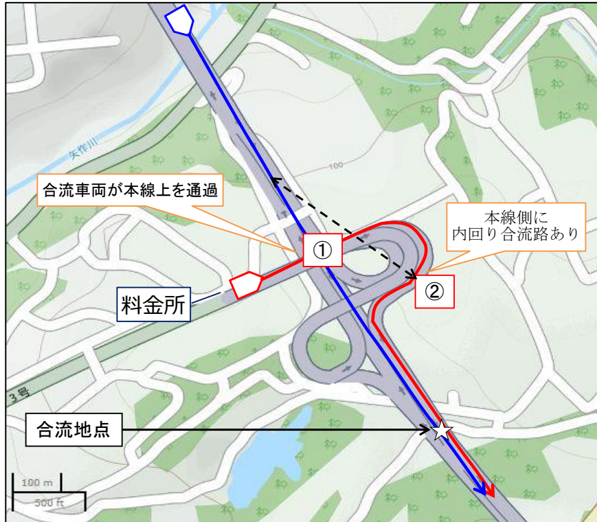
図 5.2.4.2-18 合流地点経路図（東海環状：豊田勘八 IC）
