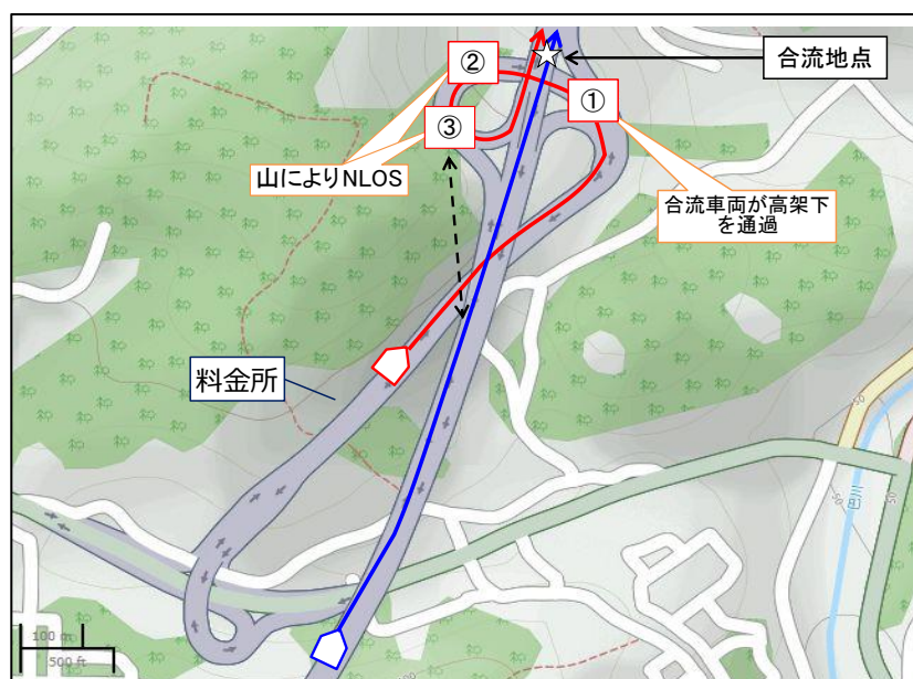
図 5.2.4.2-9 合流地点経路図 (東海環状：豊田松平 IC)
