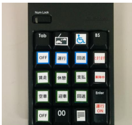
図 5-7 7 送信用車載機操作用キーボード
