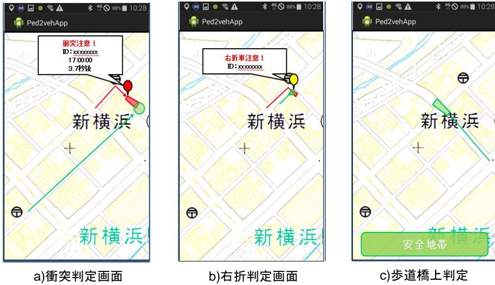
図 6.1-2 危険回避アプリケーション ユーザインタフェース画面例
