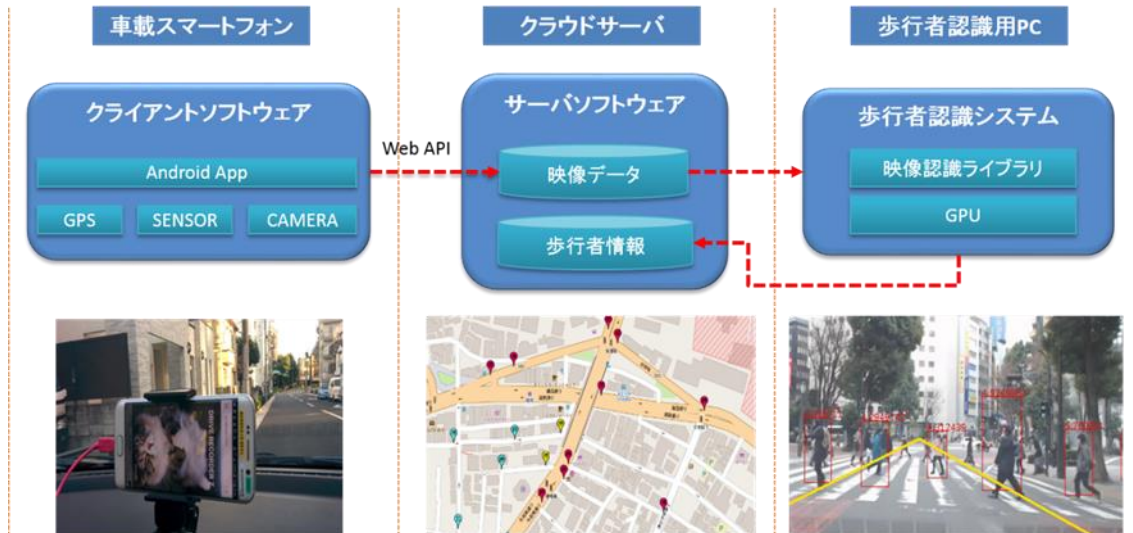
図 4-3-1 歩行者交通情報開発システム構成図
