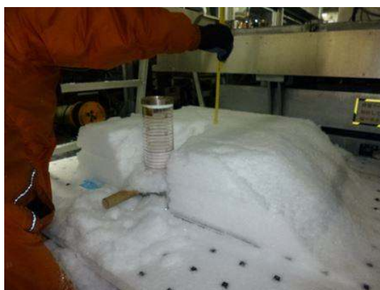
図 5.3.2-45 雪密度の測定風景(降雪実験)
