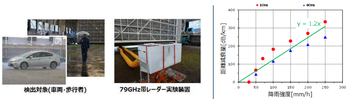
図 4.2-6 大型実験施設でのデータ取得環境(左)、降雨強度と距離減衰量の関係(右)
