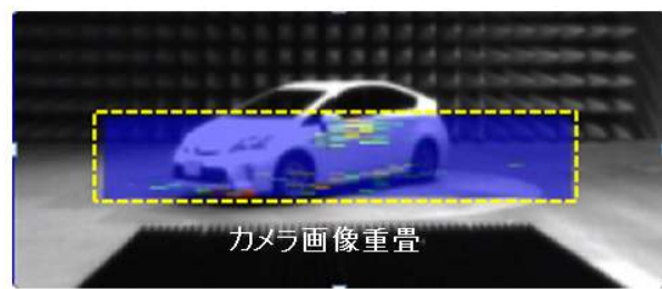
図 4.2-4 実車両を用いた干渉実験(左)、車体反射による干渉伝搬経路の実測例(右)
