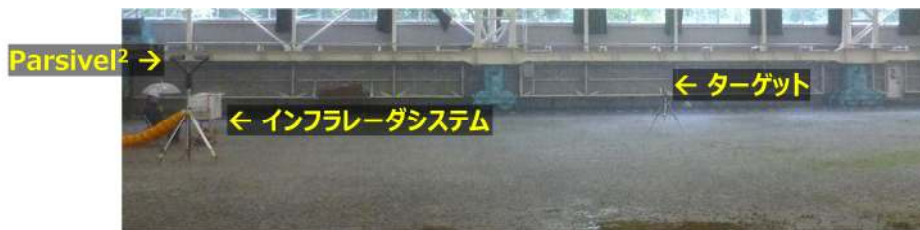
図 5.3.2-6 標準リフレクタの実験風景(降雨実験)
