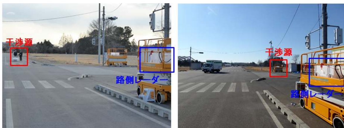
図 4.2-5 車載レーダー想定との干渉実験(左)、路側レーダー間の干渉実験(右)
