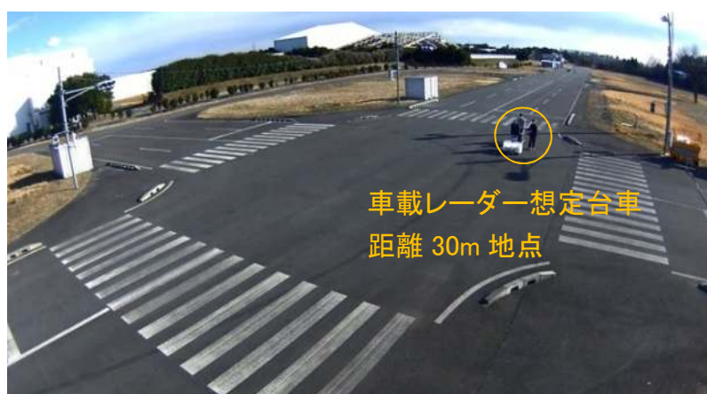
図 5.2.2.3-13 車載レーダー想定時の耐干渉性能実験
