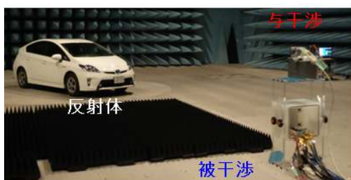
図 4.2-4 実車両を用いた干渉実験(左)、車体反射による干渉伝搬経路の実測例(右)
